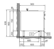
Electrical inlet (power) Equipotential screw
